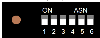
Рис.5 Кнопки переключения режимов и dip-переключатели НКМ01Т-4К
